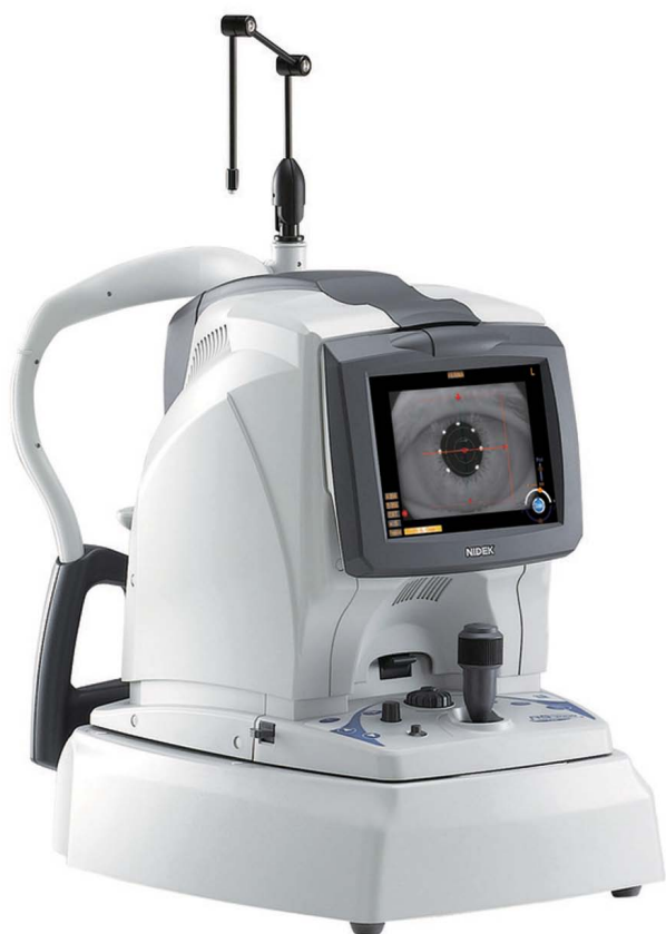
Рис. 3. Оптический когерентный томограф с режимом ангиографии NIDEK RS-3000 Advance2
