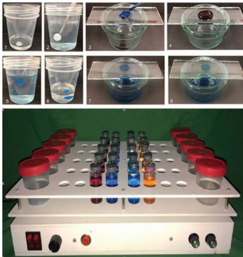
Рис. 5. Этапы приготовления цитологического микропрепарата на предметном стекле и автоматизированной подвижной платформе для серийной подготовки импрессионно-цитологических препаратов
