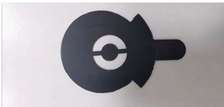
**Рис. 2.** Диафрагма в виде двух полукруглых сегментов
