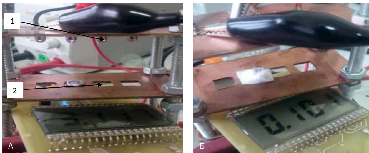
Рис. 1. Измерение проницаемости склеральной ткани для ультрафиолета А: а) общий вид измерительной установки: 1 — светодиод, излучающий ультрафиолет; 2 — датчик УФ-радиометра; б) измерение проницаемости склерального образца для УФ-А
