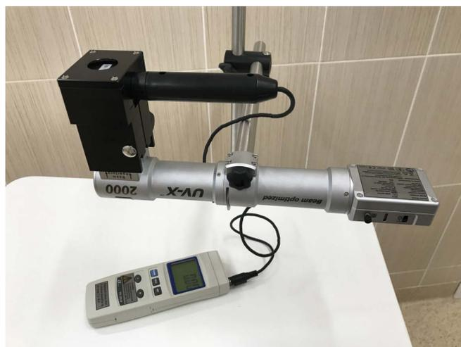
**Рис. 1.** Система генерации УФ-излучения UV-X, версия 2000 (IROC AG, Швейцария)
