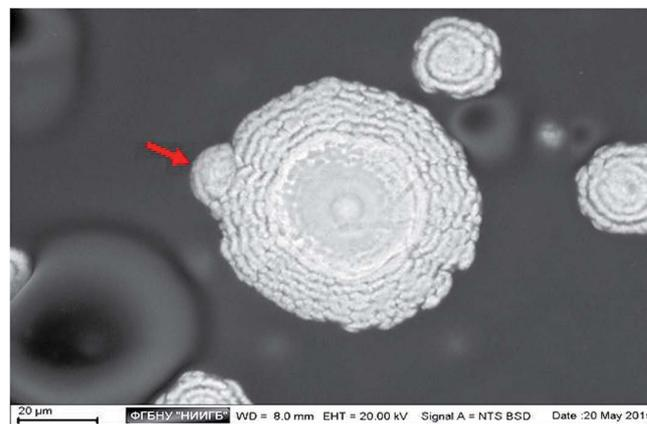
**Рис. 9.** Сканирующая электронная микроскопия 3-го образца ИОЛ. Осцилляторная зональность и уплощение в центре отдельного кристалла, к основному «взрослому» кристаллу примыкает отпочковывающийся «молодой» кристаллический индивид (стрелка)
