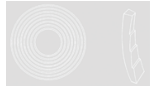
Рис. 4. Схема и профиль дифракционной линзы
